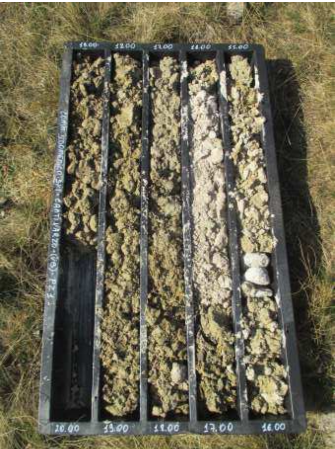
da -15.0 m a -19.50 m (oltre i 19.50 m: trovante lapideo, avanzamento a distruzione)
